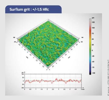
Rz : 74 μm – Rmax : 79 μm – Pc : 71 /cm
