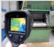
Überprüfung des Strahlbildes mithilfe der WA CAM-Technologie
