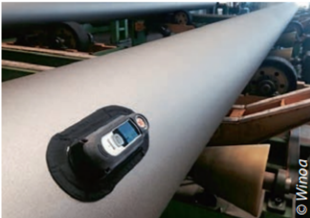
Une utilisation pratique de l'appareil de mesure permet d'optimiser le temps de grenailage en évitant la sur – qualité
