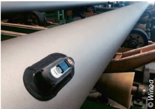
測定装置の実用的用途では、過剰ブラストを防止してブラスト時間を最適にできる
